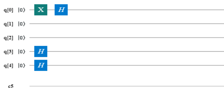
圖 3.2:用 F(x_1, x_2) = x_1 \wedge x_2 構建解決方案空間的量子電路,以可適應性問題實例。
